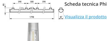
Scheda tecnica Philips LED Trunking Maxos 4MX900 LED90S 840 PSD 1800
